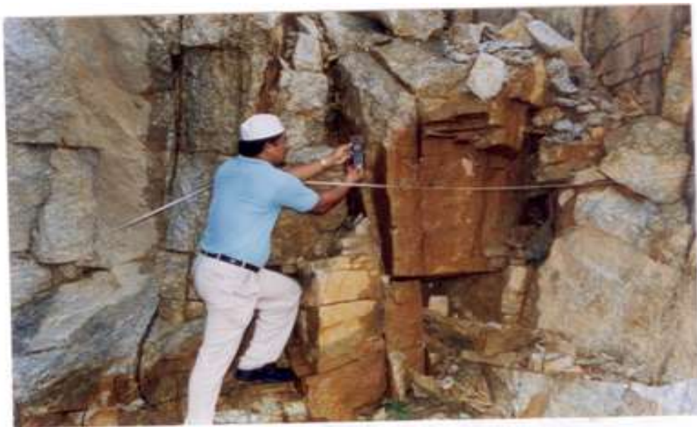
Gambar 4 : Kompas geologi : Alat yang digunakan untuk mengukur sudut kecondongan dan arah kecondongan kekar
