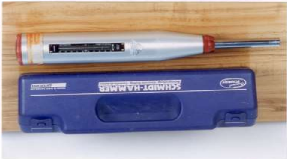
Gambar 7 : Schimdt Hammer : Alatan yang digunakan untuk pengukuran kekuatan mampatan ekapaksi pada dinding kekar
