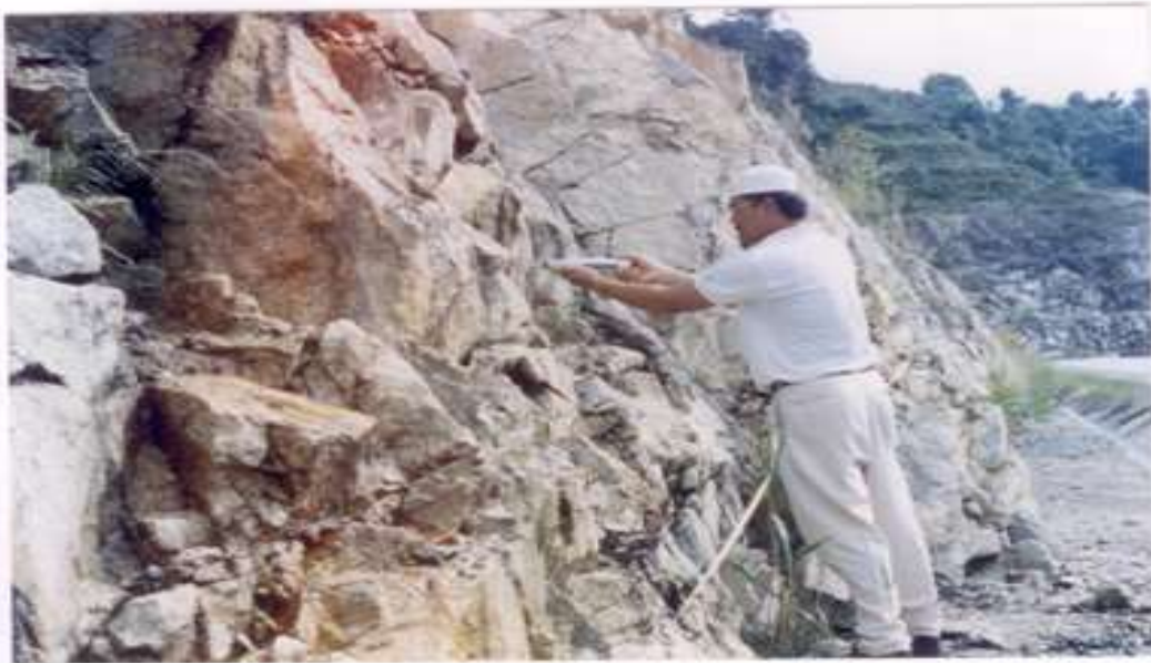
Gambar 6 : Schimdt Hammer : Alat untuk Pengukuran Kekuatan Mampatan Ekapaksi (UCS) pada dinding kekar
