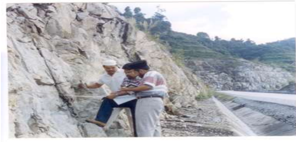
Gambar 3 : Pengukuran Jarak Kekar : Pita ukur digunakan untuk mengukur jarak antara satah kekar.
